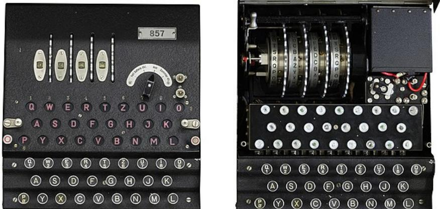
FIGURE 1 – Clavier d'Enigma, capot fermé (gauche) et ouvert (droite)
